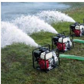
ปั๊มระบายน้ำ ปั๊มโดโว (Sump Pump)
